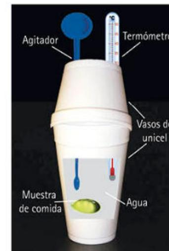
3.22 Es posible construir un calorímetro eficiente con dos vasos de unicel (poliestireno expandido), un termómetro y un agitador. En uno de los vasos se verifica la reacción y se mide el cambio de temperatura, aunque en estos recipientes no puede llevarse a cabo cualquier reacción.
