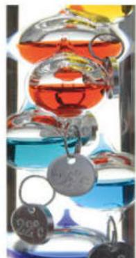
1.32 Este termómetro que inventó Galileo funciona debido a los cambios en la densidad de los líquidos cuando cambia la temperatura.
