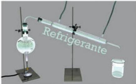
1.46 En la destilación simple, los vapores del primer líquido que llega a su temperatura de ebullición pasan por el refrigerante, donde se condensan, y el líquido se recolecta puro.
