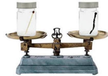
1.57 Si se pesan los dos frascos antes y después de la combustión, se comprueba la Ley de conservación de la masa.
